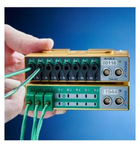
IPETRONIK의 새로운 온도 모듈 M-TDC 8 는 특허받은 TDC 기술을 사용하여 측정 지점과 모듈의 커넥터 조립없이 접촉가능한 첫번째 온도 모듈을 만들었습니다. 센서 케이블은 모듈에 직접 삽입되어 자동으로 접촉 및 연동됩니다. 온도 센서 셋업시 커넥터 조립시간의 허비 없이 소중한 시간을 절약하고 작업 흐름을 더욱 향상시킵니다.
